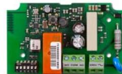
**JA-151N Funk PG Ausgangsrelaismodul (60 V DC, 2 A)**
